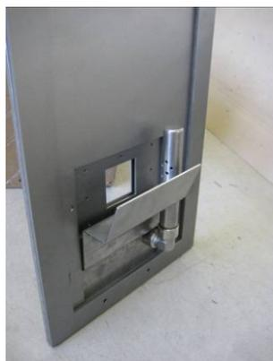
Vista interior con bandeja acumuladora y mandril de propulsión neumático
