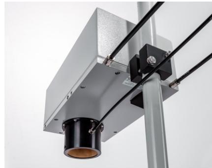
Mediante la generación de una ligera sobrepresión dentro del cilindro de medición se evita la suciedad.
